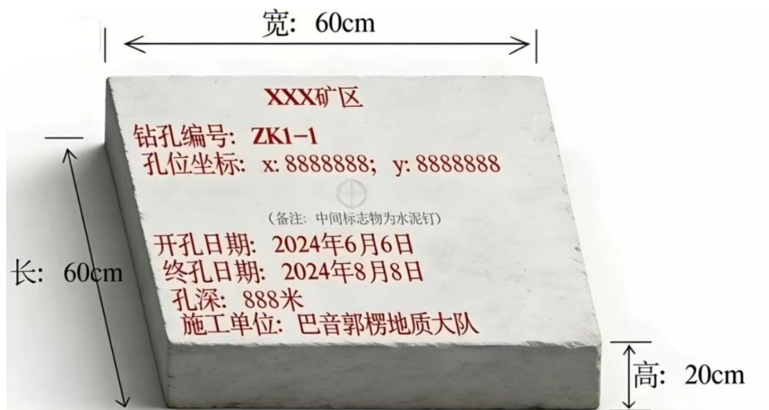
图 1-钻孔孔口立桩标志示意图
